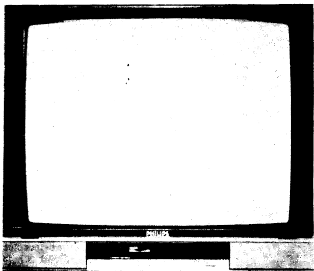
27. ábra. A bemutatókhoz igyekezzünk beszerezni igen nagy képernyőjű, jó minőségű, korszerű készüléket. A képen a Philips gyártmányú, V6851 típusú, 70 cm-es képátlójú szuperszögletes, lapos képernyőjű készüléket láthatjuk. A 2 \times 30 W kimeneti teljesítményű Hi-Fi végfokozat, a képélességet javító áramköri megoldások kifejezetten alkalmassá teszik a készüléket minőségi bemutatások céljára.
