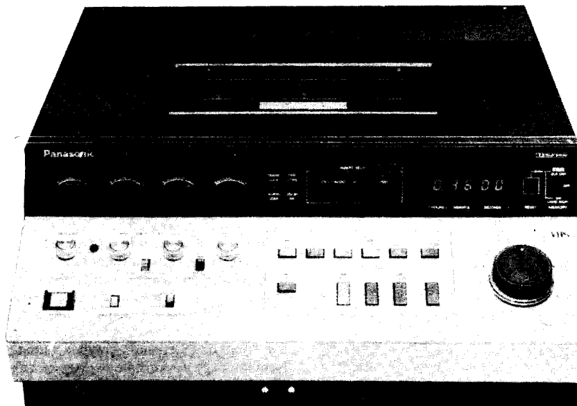
35. ábra. Számos hazai kis videostúdió rendezkedett be a Panasonic gyártmányú NV-8500 típusú VHS PAL szerkesztőmagnóval történő üzemre. A teljes körű szerkesztési képességek kivül időköddal történő vágásra is alkalmas a készülék. A fejdob hat forgófejet tartalmaz, a szerkesztési, szalagkezelési munkát öt motor segíti. A készüléket mindig párosan használják.
