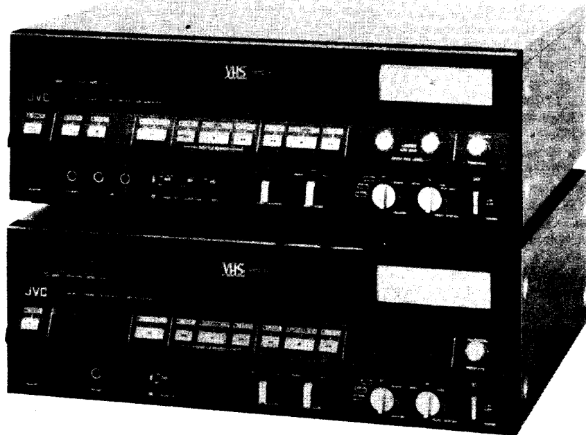
34. ábra. A JVC gyártmányú BR-6400TR és BP-5300TR VHS szerkesztőmagnó-páros PAL- és SECAM-jelek kezelésére alkalmas. A készülékpáros mindent tud, ami a képszerkesztéshez szükséges. Alkalmas megfelelő távvezérlő segítségével U-matic rendszerrel való együttműködésre is (vágásra!)
